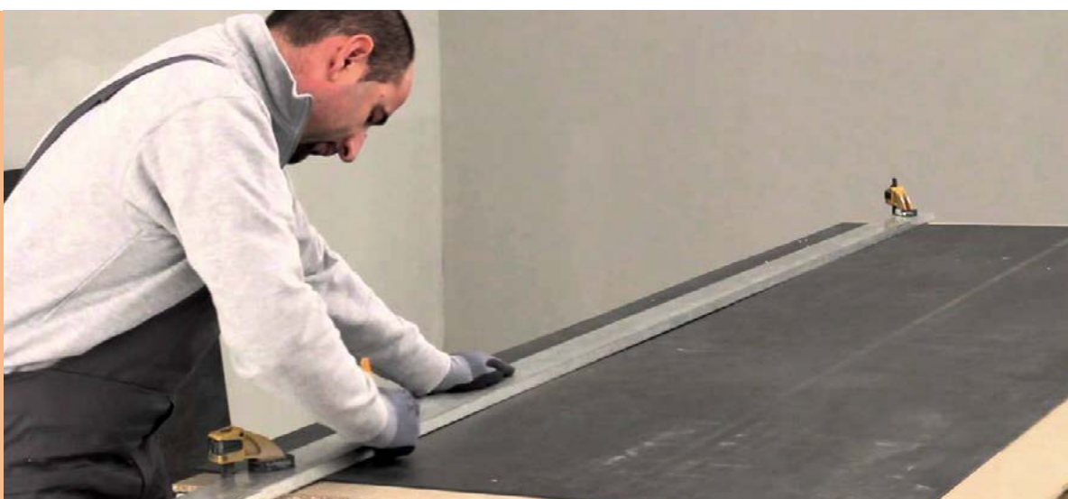
Zdjęcie 7 // Cięcie płyty LAMINAM® za pomocą noża
